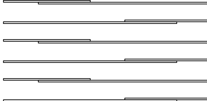
Схема перехлеста арматурных стержней вразбежку
