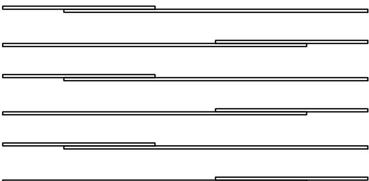
Схема перехлеста арматурных стержней вразбежку
